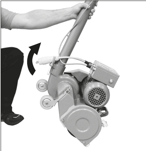
Abb. 1 Die Maschine etwas nach vorne kippen.
